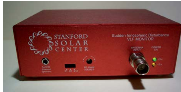
Abb. 2: Ein solcher Empfänger [4] ermöglicht die Langzeitbeobachtung von Anomalien bei der Ausbreitung des 24kHz-Signals in der Ionosphäre.
